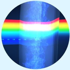
Absorción por masa: la luz azul es absorbida por su filtro bloqueador que forma parte del sustrato del material del lente.
